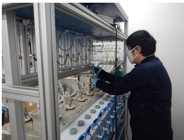
写真2 福島県における電解濃縮装置の運用
